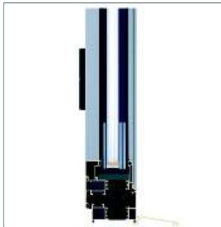
Sistema de ventana abisagrada de 70 mm, cuya potente capacidad de aislamiento, con un valor de transmitancia de marco de sólo 1,7 W/m²K, se logra gracias a la perfecta conjunción y diseño de periferia de aluminio, varillas de poliamida tubulares de 35 mm, juntas de estanqueidad tubulares E.P.D.M. y un sistema de espuma de poliolefina colocada perimetralmente en el galce del vidrio.
